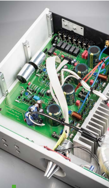
Główna pojemność filtrująca wynosi 40 tys. \mu\text{F} . To dość typowa wartość w tej klasie.
